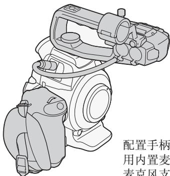
配置手柄：安装手柄以使用内置麦克风、XLR 端子、麦克风支架等（[图 70](#)）。
